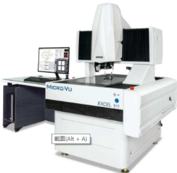
光学影像测量仪它是在测量投影仪的基础上进行的一次质的飞跃，它将工业计量方式从传统的光学投影对位提升到了依托于数位影像时代而产生的计算机屏幕测量。数字化技术实现了工件随意放置：手摇式影像测量仪在进行基准测量时，需要旋转载物平台上的分度盘，将零件的基准边调整到平行于平台的一个坐标轴，这是因为它的初级软件不能支持极其复杂空间几何换算。而数字化影像测量仪可以利用软件技术完成空间坐标系旋转和多坐标系之间的复杂换算，被测工件可随意放置，随意建立坐标原点和基准方研润企业生产向并得到测量值，同时在屏幕上呈现出标记，直观地看出坐标方向和测量点，使\*\*为常见的基准距离测量变得十分简便而直观。从此，分度盘这个机械时代的产物与摇柄一起成为历史。
